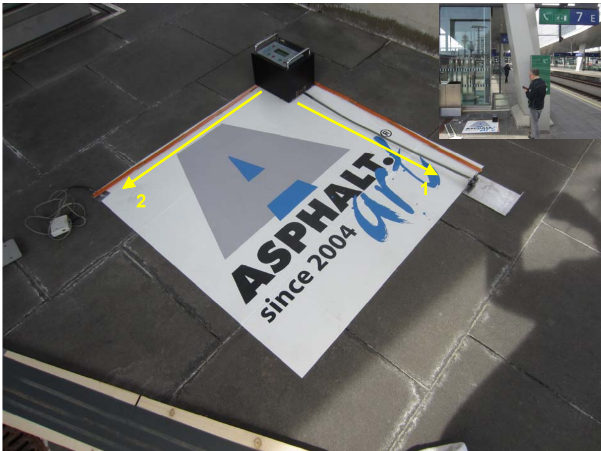
Bild 01.: Hauptbahnhof Wien, Bahnsteig 7E; selbstklebenden Fußbodenfolie Messung „trocken“: Richtungen der Messreihen 1 und 2.
